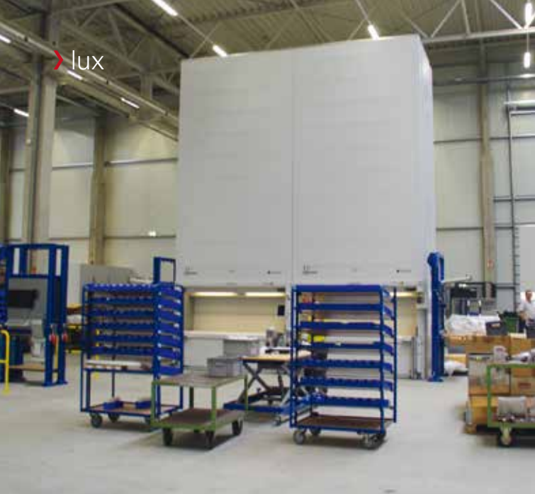
Der Lagerturm enthält Standardteile.
